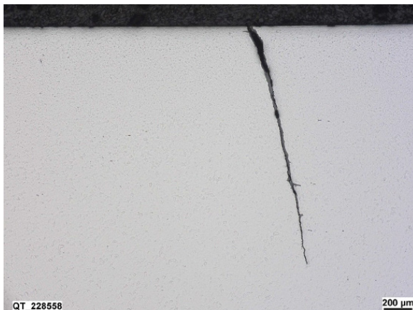
Figura 99: Immagine al microscopio ottico della superficie di rotolamento intatta della sala 3: cricca originatasi sulla superficie di rotolamento e a propagazione più o meno verticale rispetto alla superficie, senza fatica per sollecitazione da rotolamento .
