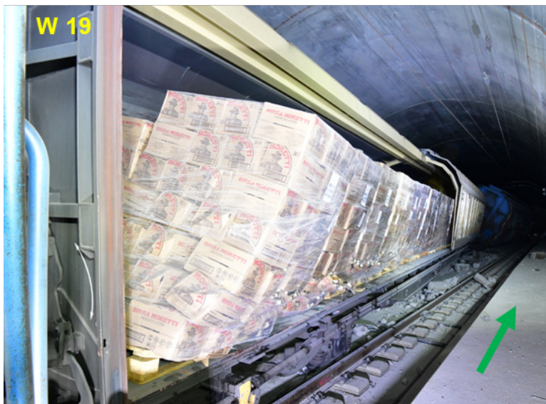
Figura 14: Carro 19 (portellone scorrevole aperto e spostamento del carico in seguito all'impatto).
