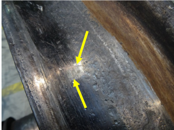
Figura 86: Ricontri visivi di cricche sulla superficie.
