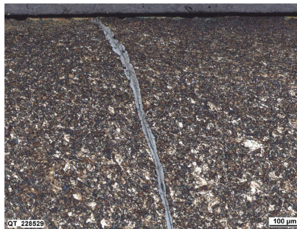
Figura 76: Micrografia, cricche riempite di prodotti.
