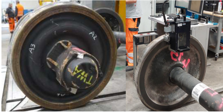
Figura 70: Foto di una sala montata durante la misurazione delle tensioni residue.
