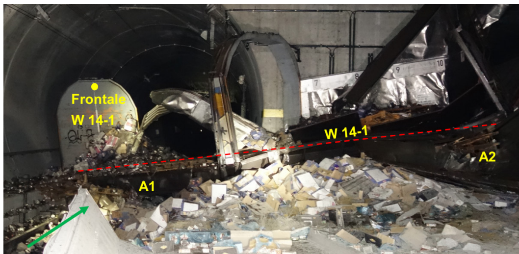
Figura 10: Immagine dettagliata del carro 14-1. La linea rossa tratteggiata riproduce la posizione del pavimento del carro.
