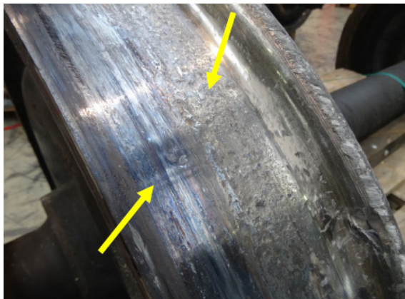
Figura 83:. Colorazione blu sulla superficie di rotolamento. Frecce gialle: riscontri di cricche.
