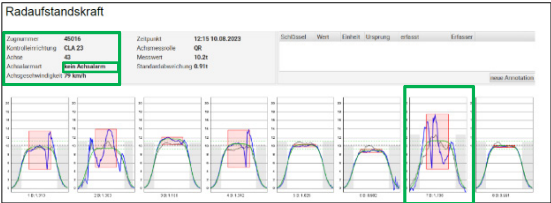
Figura 94: Registrazione ICT delle forze di appoggio delle ruote: RLC di Claro, treno 45016, data 10.08.2023.
