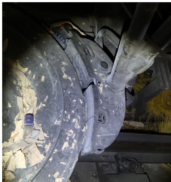
Figura 12: Ruota destra, in direzione di marcia, dell'assile 4 del carro 14-2. La metà posteriore del carro non ha sbattuto contro la porta di cambio corsia, fermandosi prima. L'assile era sospeso nella sua posizione originaria, i freni erano allentati.
