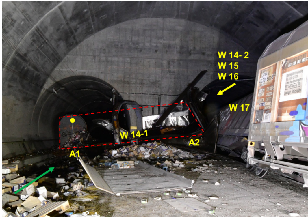
Figura 9: Il carro 14-1, completamente distrutto, è appoggiato trasversalmente alla parete della galleria sulla mensola centrale (immagine scattata in direzione di marcia) tra il binario 7000 e il binario di raccordo alla canna est. La linea rossa tratteggiata riproduce il profilo effettivo del carro 14-1. I carri 14-2, 15 e 16 si sono fermati all'interno della galleria di raccordo in direzione della canna est.
