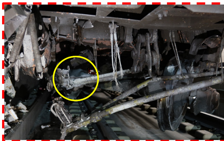
Figura 6: Immagine dettagliata dell'assile. Nel cerchio di colore giallo si vede ciò che resta della ruota spezzata. In primo piano il triangolo del freno anteriore, in direzione di marcia, pendente verso il basso.
