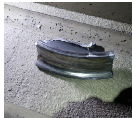
Figura 38: Frammento di ruota staccatosi dall'assile 1 del carro 11.
