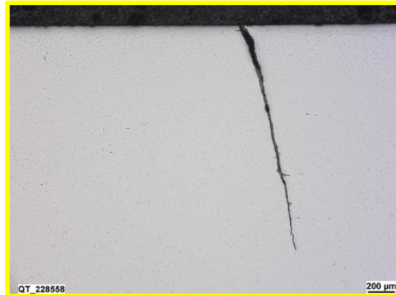
Figura 88: Ruota intatta dell'assile 3 con cricca verticale, senza deformazione plastica. Per i dettagli si rimanda all'allegato 6, Figura 100.
